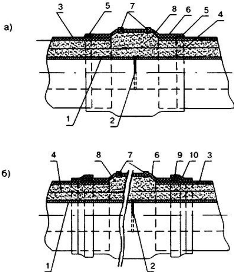
а - "сварка-заливка"; б - "герметизация-заливка"
