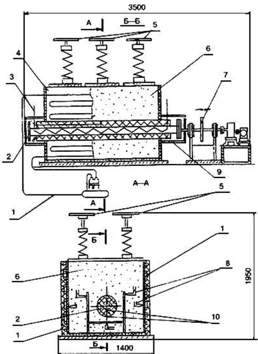
1 - система охлаждения; 2 - фрагмент теплопровода; 3 - нагреватель; 4 - камера; 5 - нажимное устройство; 6 - грунт; 7 - механизм протяжки; 8 - размещение термопар в камере стенда; 9 - теплоизоляция концевых участков; 10 - размещение термопар на фрагменте теплопроводов
